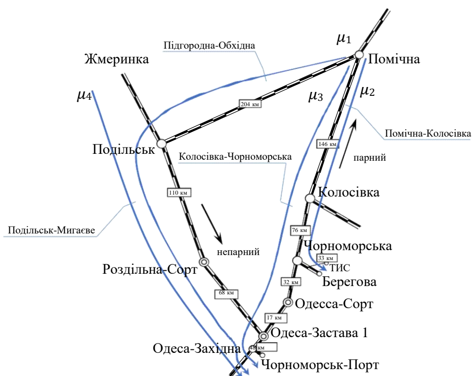
Рис. 1. Граф полігона мережі регіональної філії «Одеська залізниця» АТ «Укрзалізниця» та маршрути руху поїздопотоків
