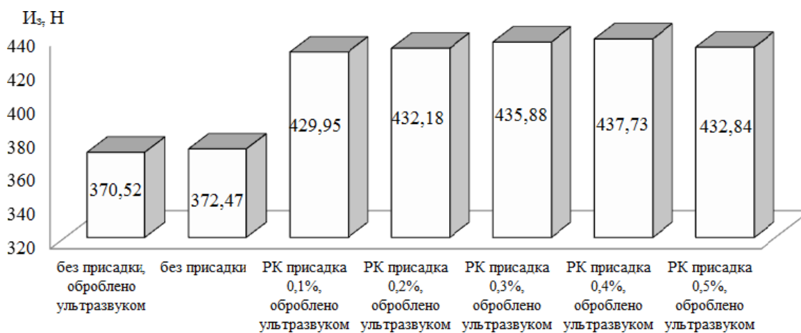
Рис. 2. Залежність зміни індексу задиру від концентрації присадки в оливі Mobil Hydraulic 10W
