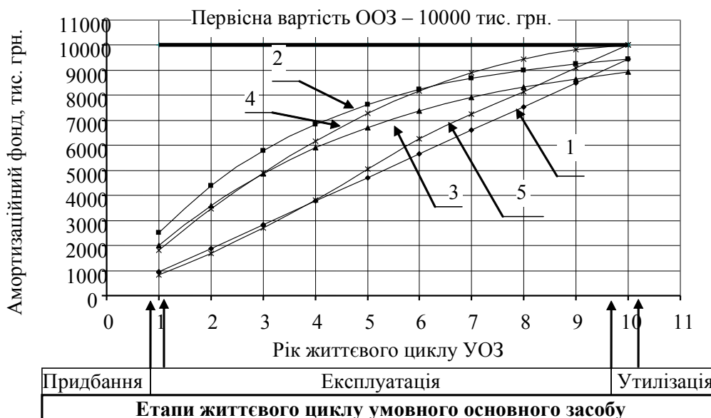
Рис 1 – Формування амортизаційного фонду за етапами життєвого циклу УОЗ: 1 – прямолінійний метод; 2 – метод зменшення залишкової вартості; 3 – метод прискореного зменшення залишкової вартості; 4 – кумулятивний метод; 5 – виробничий метод.
