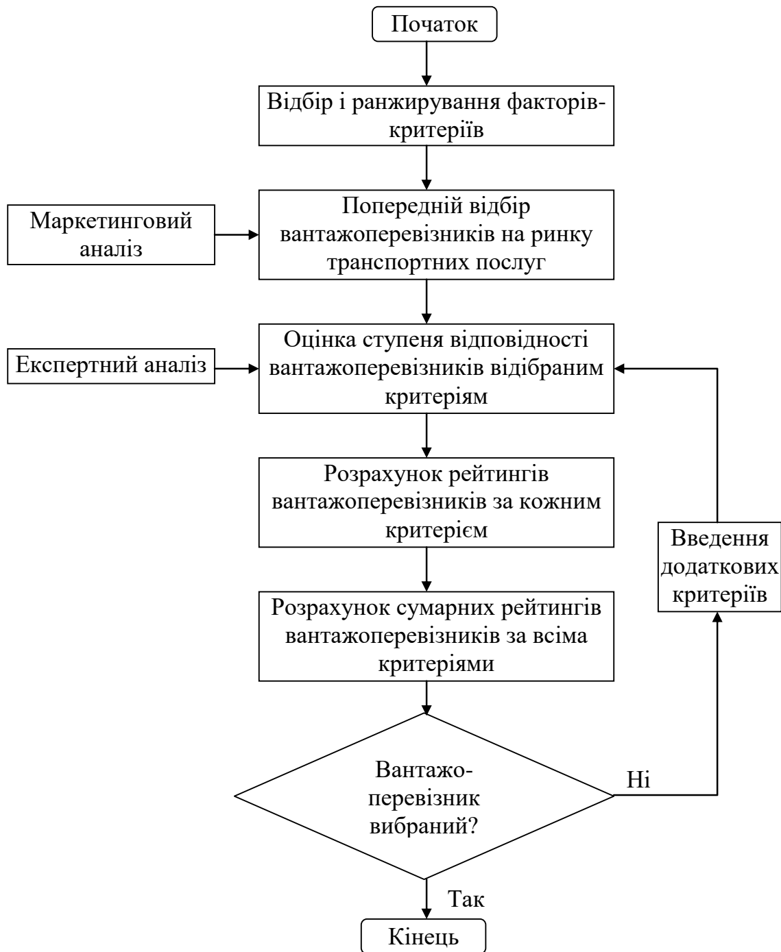
Рисунок 7.1 - Блок-схема алгоритму вибору вантажоперевізника з використанням методу експертних оцінок
