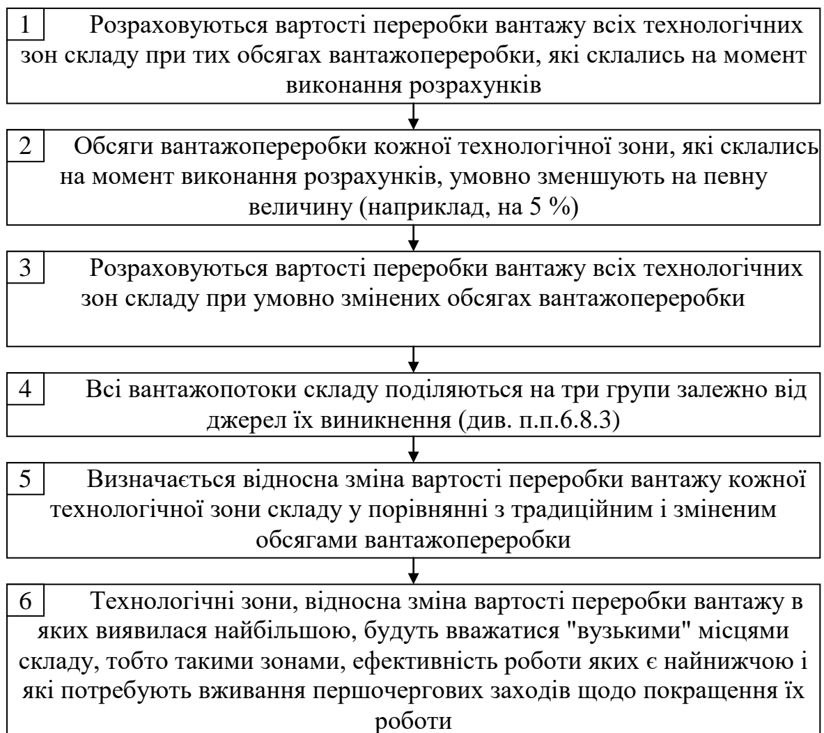
Рисунок 6.17 - Блок-схема алгоритму дій щодо виявлення можливостей підвищення економічної ефективності роботи складу
