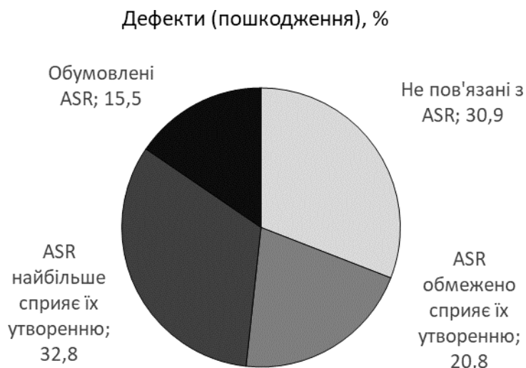
Рис. 5. Розподіл частки дефектів (пошкоджень) від їх загальної кількості за їх зв'язком з корозією бетону, обумовленою ASR
