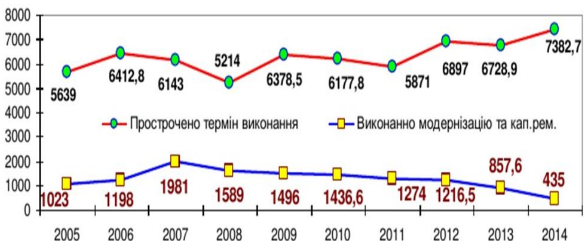
Рис. 1. Виконання обсягів модернізації та капітального ремонту колій у порівнянні з величиною прострочених кілометрів [14]
