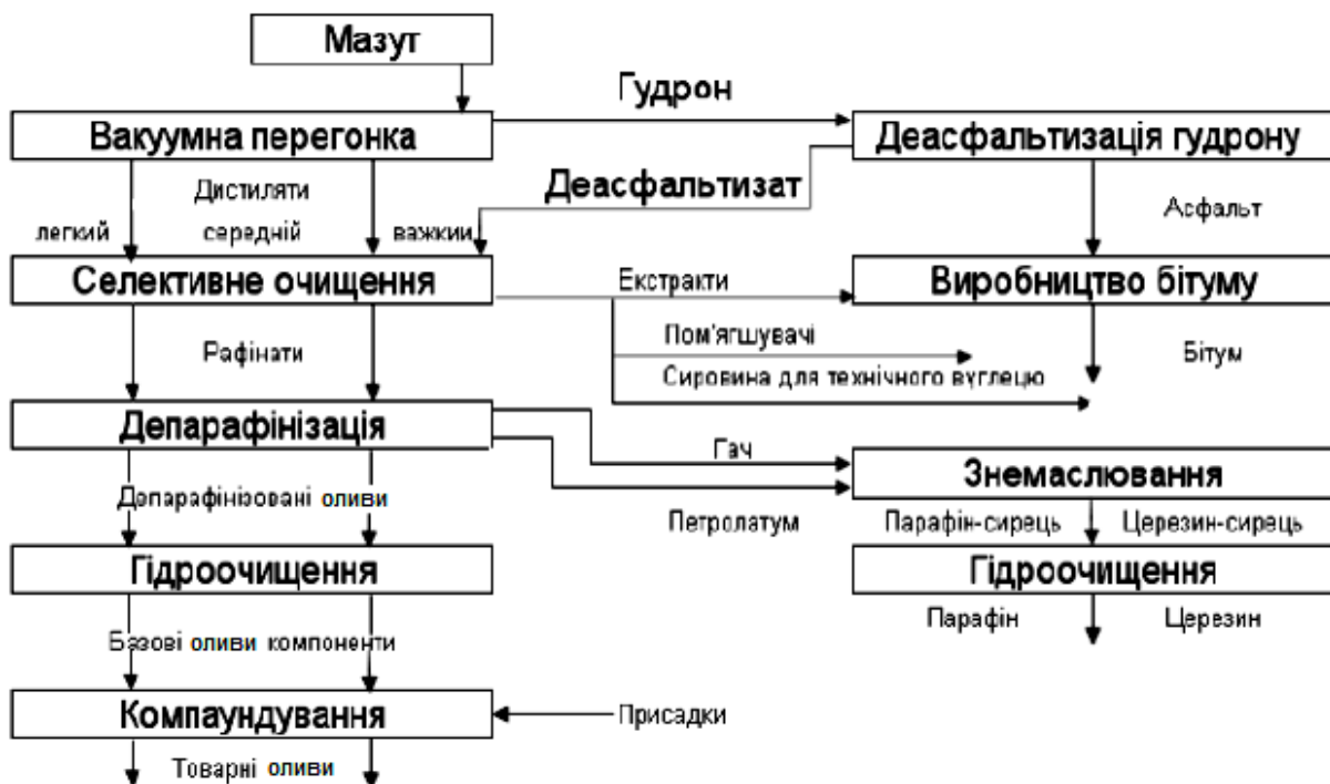
Рис. 3.5. Схема отримання олив з мазуту
