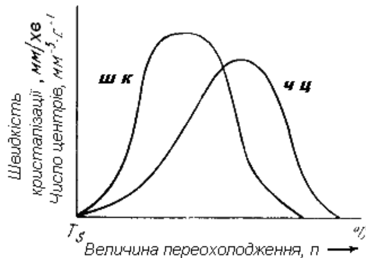
Рисунок 5 - Залежність числа центрів кристалізації (а) і швидкості росту кристалів (б) від ступеня переохолодження
