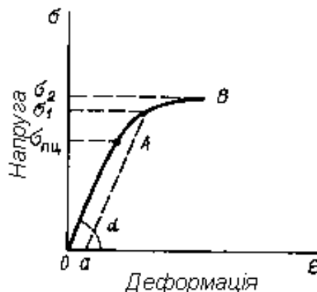
Рисунок 9 - Діаграма залежності деформації металу \epsilon від діючих напружень \sigma
