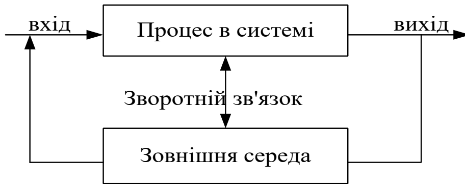
Рисунок 7.1 - Компоненти «чорного ящика»
