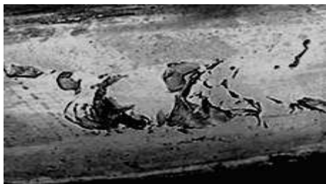
Рис. 4. Вищербина I типу гальмівного походження
