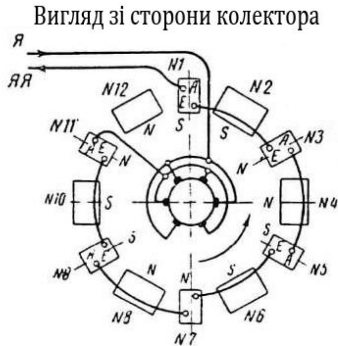
Рисунок 8 – Схема з'єднання обмоток додаткових полюсів
