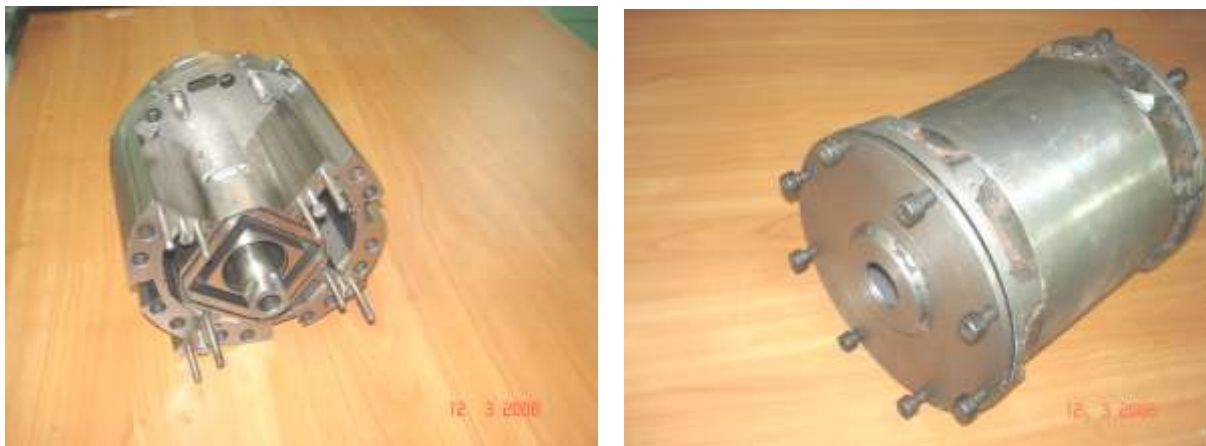
Рис.5. Дослідний компресор для систем повітропостачання моторвагонного рухомого складу
