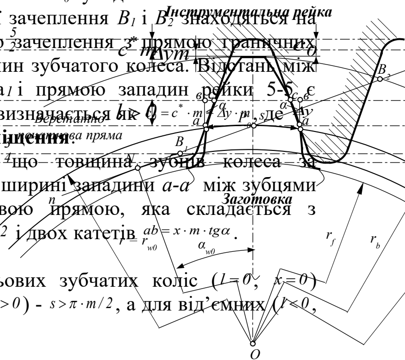
Рисунок 1.22 - Рейкове верстатне зачеплення при нарізанні зубчатого колеса з додатним зміщенням інструменту.
