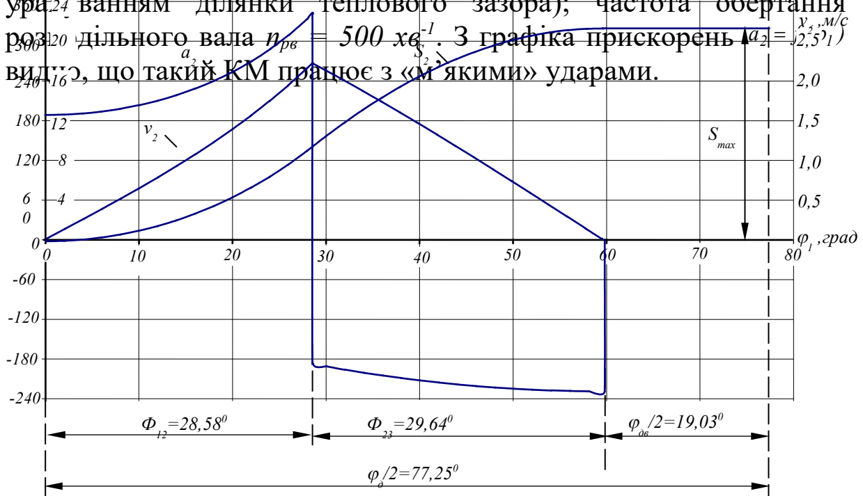
Рисунок 3.10 - Кінематичні характеристики поступального роликового штовхача кулачкового механізму газорозподілу тепловозного дизеля типу Д80 з тангенціальним кулачком
