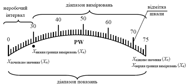
Рисунок 9.2 – Структура шкали аналогового приладу
