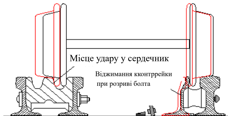
Рисунок Б.9 – Аварійна ситуація при розриві контррейкового болта
