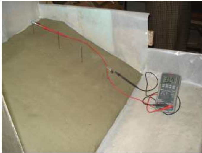
Рис. 15. Модель для вивчення зміння властивостей ґрунтовмісних матеріалів в умовах накопичення надлишкових зарядів
