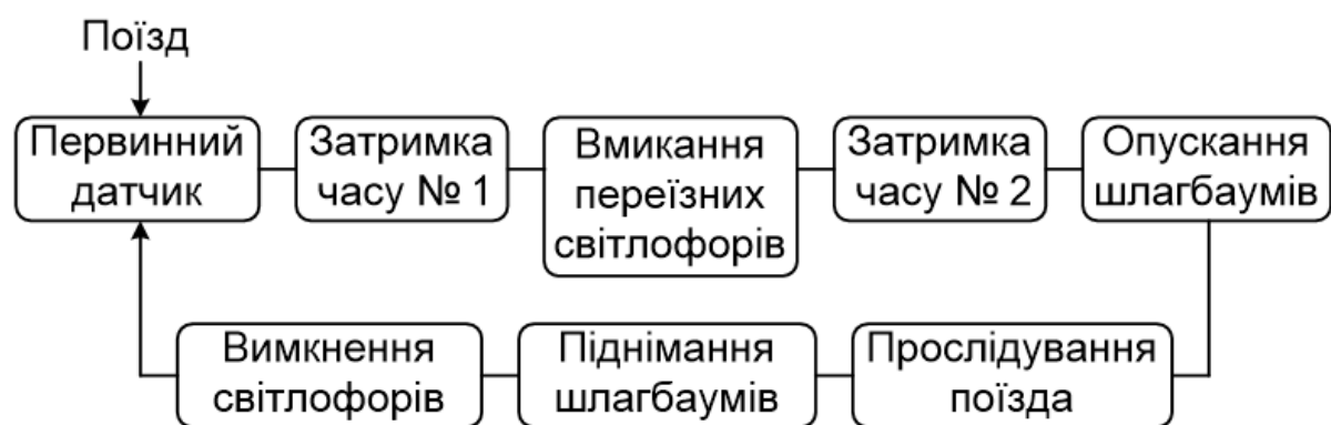
Рис. 4.3. Структурна схема роботи переїзду
