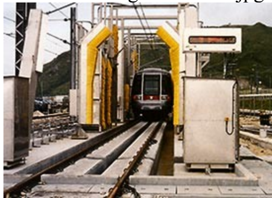
Рисунок 14 – Сучасна мийна установка
