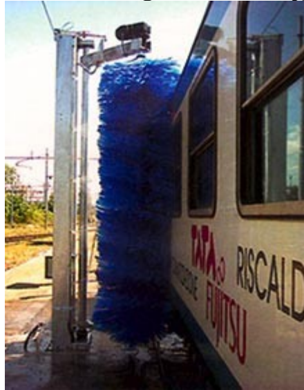
Рисунок 13 – Бічна вертикальна щітка мийної установки
