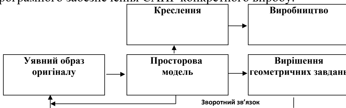
Рисунок 5.3. – Схема технології конструювання на базі ПГМ
