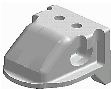
Рисунок 7.7 – Рендерингована тривимірна модель клина вантажного візка
