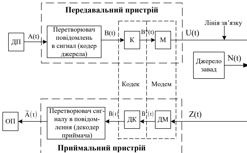
Рисунок 1.2 – Узагальнена структурна схема системи передачі інформації
