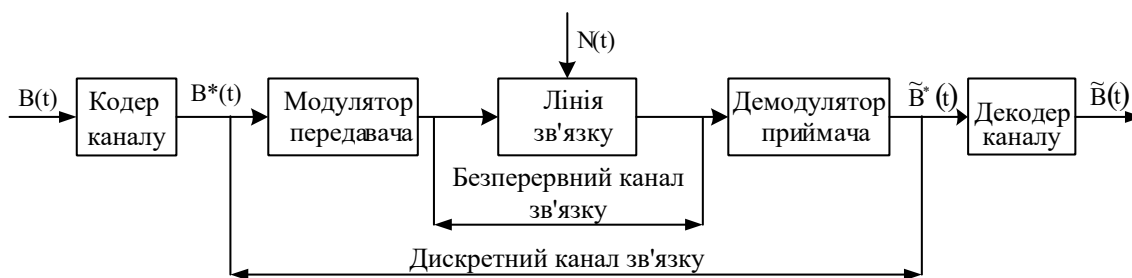
Рисунок 1.3 – Структурна схема каналу зв'язку
