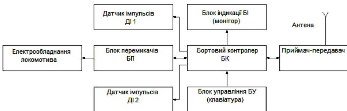
Рисунок 2 – Склад локомотивної апаратури маневрової автоматичної сигналізації
