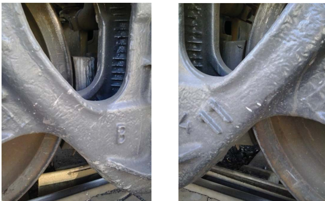
Рис. 13 – Зазори між елементами триботехнічної пари «гальмова колодка – колесо» у візку вантажного напіввагона з модернізованими ГВП
