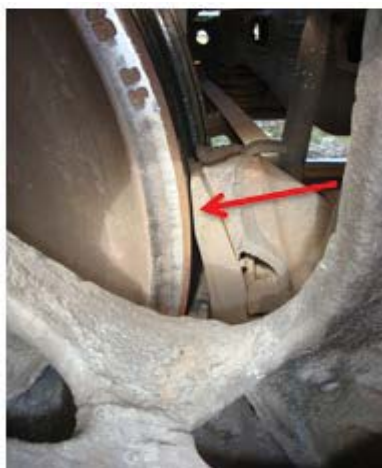
Рис. 1 – Вигляд схилених колодок візка вантажного вагона під час руху без гальмування
