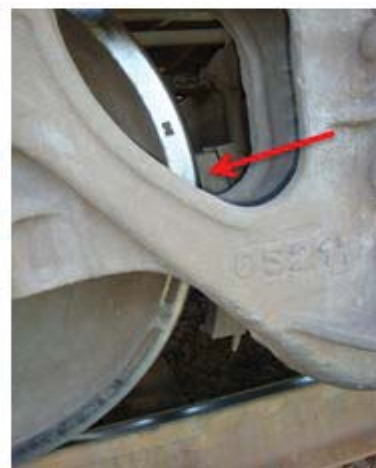
Рис. 1 – Вигляд схилених колодок візка вантажного вагона під час руху без гальмування
