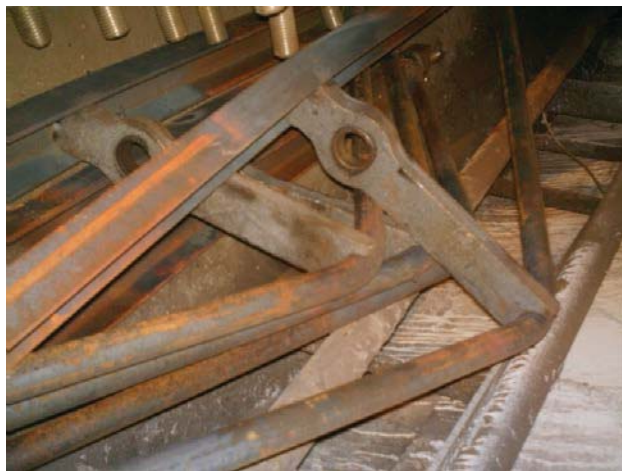
Рис. 4 – Вигляд модернізованого триангеля з перенесеним отвором у його розпірці на 112 \pm 2 мм у бік швелерної балки
