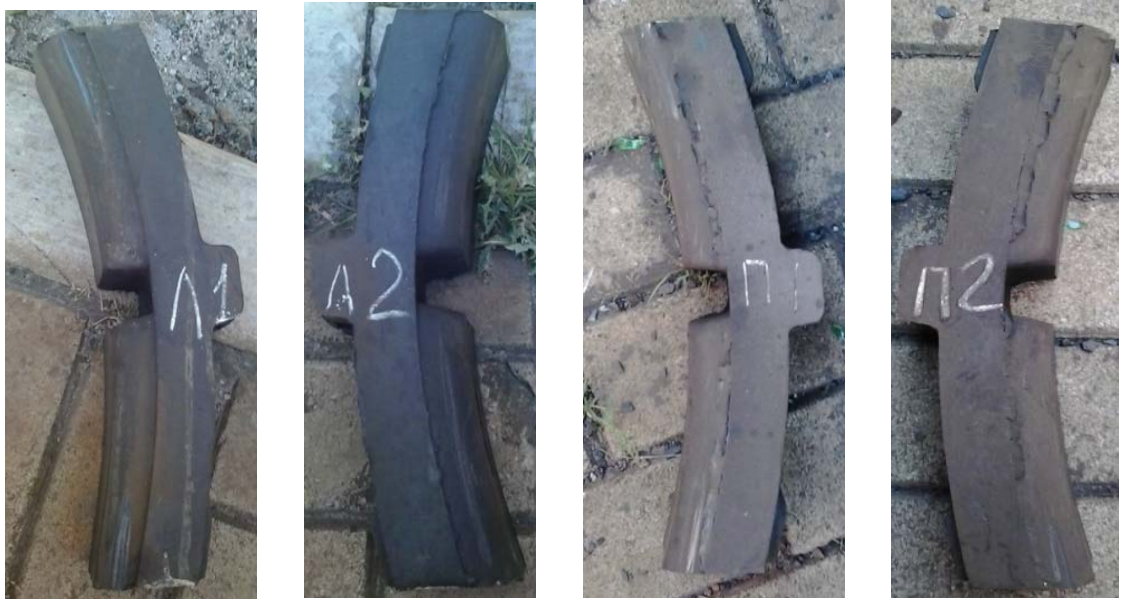
Рис. 14 – Вигляд композиційних гальмових колодок дослідних напіввагонів з рівномірним зносом за товщиною після тривалої експлуатації
