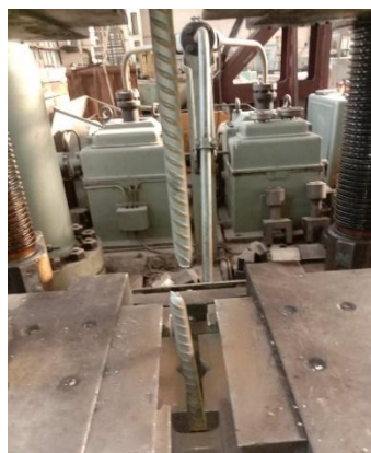
Рис. 2. Арматура після випробування
