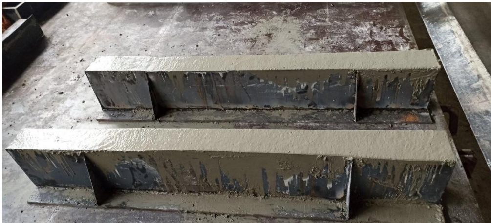
Рис. 2. Виготовленні зразки сталезалізобетонних балкових згинальних елементів з армуванням листами
