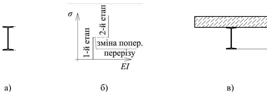
Рис. 1. Демонстрація генетичної нелінійності роботи сталезалізобетонних перекриттів під час їх виготовлення: а) 1-й етап виготовлення – влаштування сталеві балкової клітки; б) схема зміни жорсткості перерізу; в) 2-й етап виготовлення – влаштування монолітної залізобетонної плити
