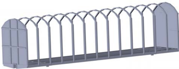
Рис. 2. Каркас кузова критого вагона
