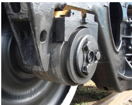
Рис. 16. Буксовий вузол з касетним підшипником у візку з адаптером
