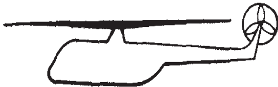
Рис. 1. Вертоліт одногвинтової схеми з рульовим гвинтом
