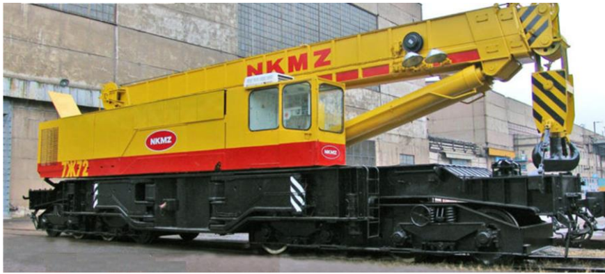
Рисунок 1.2 – Кран на залізничній колії з телескопічною стрілою
