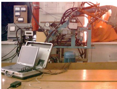
Рисунок 3.7 – Діагностування стану гідросистеми екскаватора-стенда за величиною загального ККД при застосуванні вимірювального комплексу
