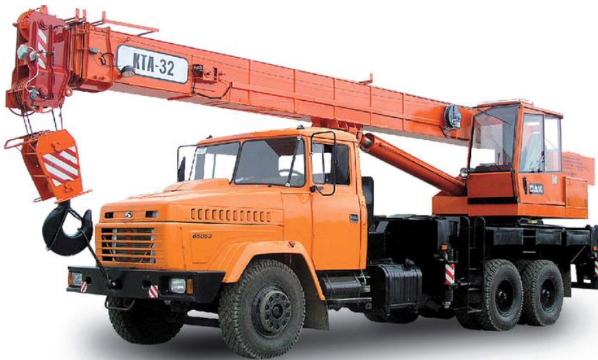
Рисунок 1.3 – Мобільний стріловий кран із телескопічною стрілою
