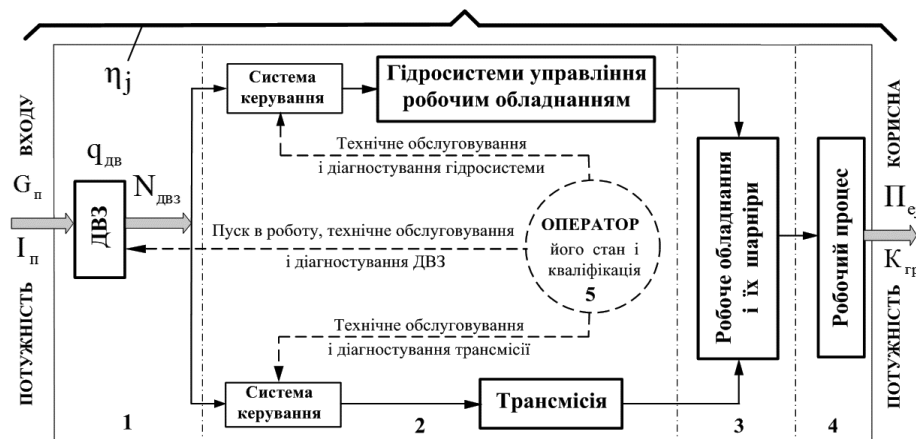
Рисунок 2.2 – Структурна схема ЗМ в робочому режимі
