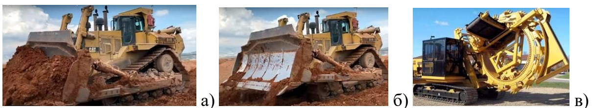
Рисунок 1.3 – Особливості робочого процесу бульдозера і конструктивне виконання робочого обладнання роторного екскаватора
