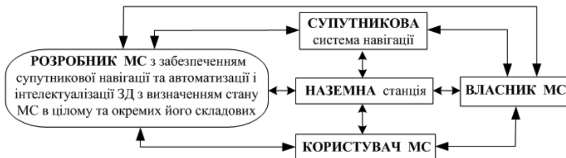
Рисунок 1.2 – Схема системи супутникової навігації з елементами дистанційного діагностування ЗМ як МС в цілому та її складових
