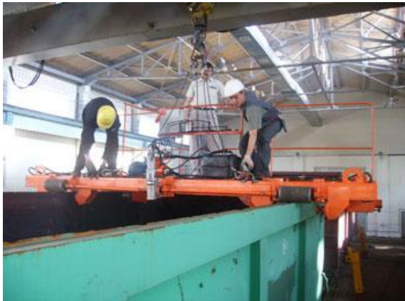
Рис. 2.5. Установа при виконанні виправлення верхнього обв'язувального поясу піввагонів
