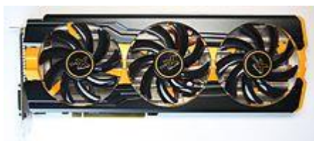
Рис. 2.13. Система охолодження на відеокарті Sapphire Radeon R9 290X
