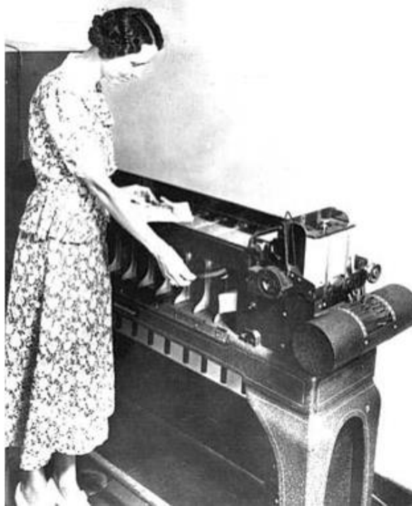
Рис. 1.2. Табулятор IBM (1937 рік), який застосовувався для механізації статистичної справи в багатьох країнах, у тому числі і в СРСР
