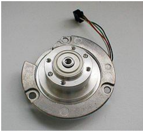
Рис. 2.6. Електродвигун привода шпинделя магнітних пластин
