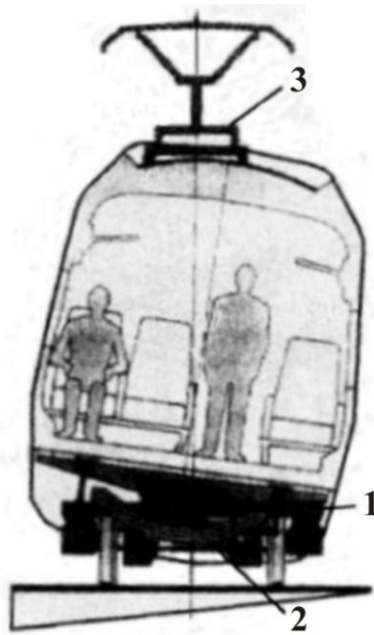
Рис. 3.16. Схема механізму активної електромеханічної системи SWING для примусового нахилу вагона в кривих залізничної колії: 1 - центральна пневматична ресора ресорного підвішування кузова вагона; 2- роликів люлька; 3 - каретка зі струмоприймачем.
