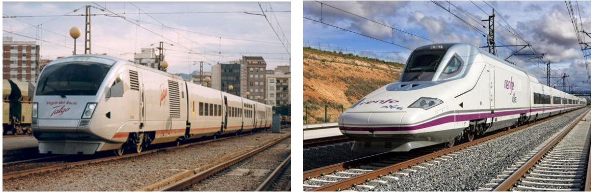
а) б) Рис. 3.32. Поїзд Talgo XXI з тепловозом (а) і електровозом (б).
