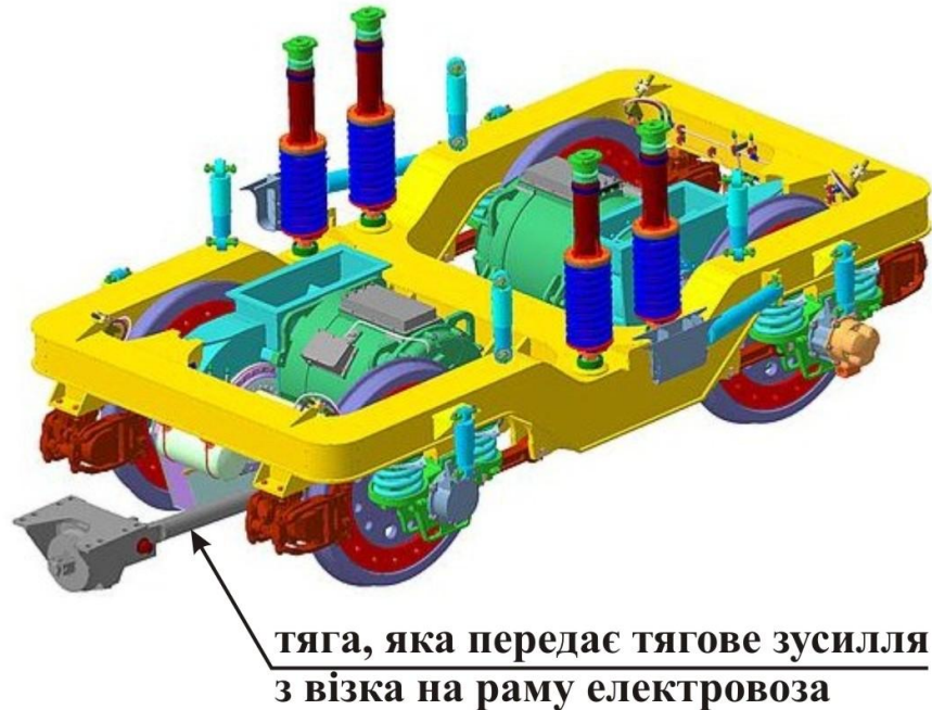
Рис. 6.20. Загальний вигляд середнього візка електровоза ЕП20 із похилою тягою.
