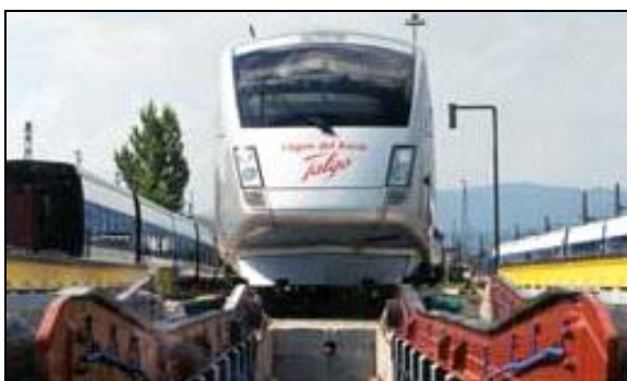
Рис. 4.38. Проїзд поїзда Talgo 350 з тепловозом (а) через пристрій зміни коліс на іншу ширину колії (б).
