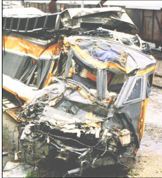
Рис. 10.10. Високошвидкісний поїзд TGV після зіткнення з 80-тонним асфальтним котком/
