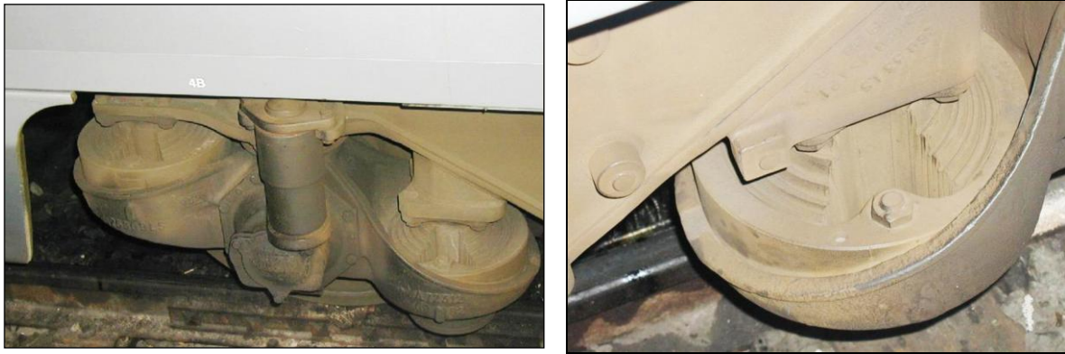
Рис. 4.11. Буксовий вузол високошвидкісного поїзда TGV з циліндричними гумометалевими блоками.
