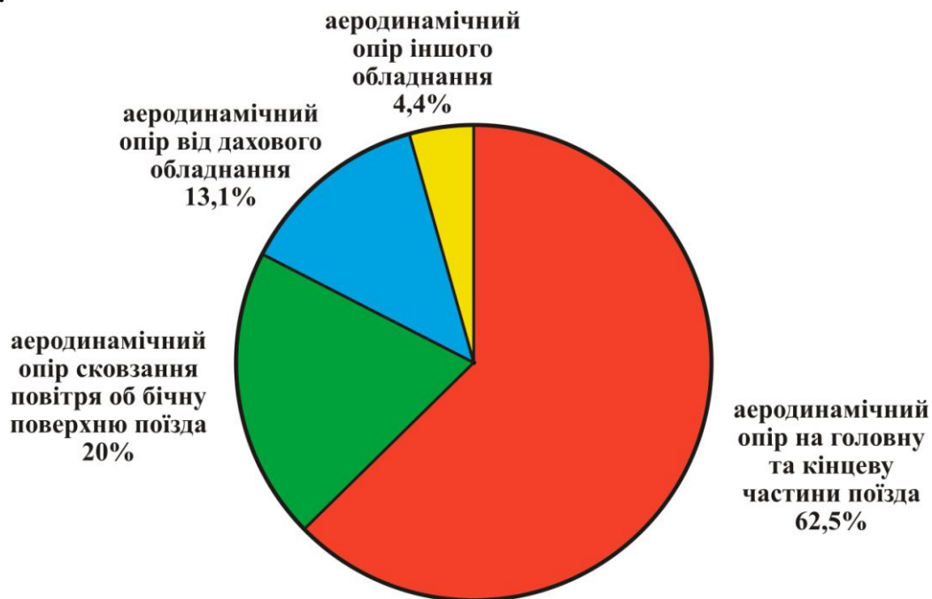
Рис. 2.9. Розподіл аеродинамічного опору руху за визначеними складовими високошвидкісного поїзда TGV.
