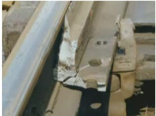
Рис. 10.2. Рух розвернутого своїм боком п'ятого вагона поїзда до опори моста (а) і зламаний гостряк стрілочного переводу № 23 (б).
