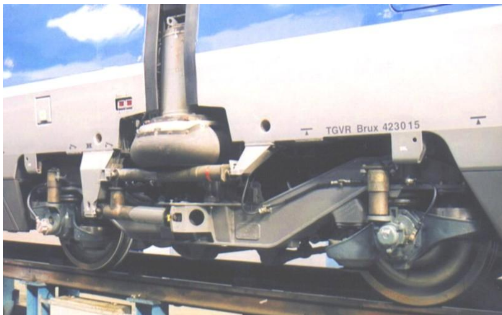
Рис. 4.5. Перероблене (модернізоване) зчленування пасажирських вагонів високошвидкісного поїзда TGV.
