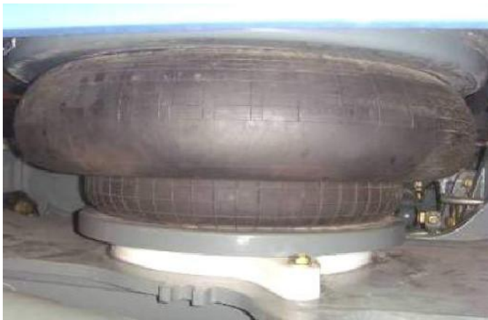
Рис. 5.14. Загальний вигляд (а) та елементи пневматичної ресори (б): 1 - зовнішня гумова оболонка; 2 - кордовий шар з металевими нитками; 3 - проміжний кордовий шар з капроновими нитками; 4 - внутрішній шар гуми.
