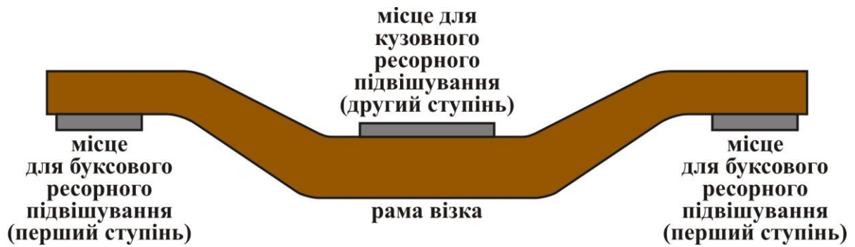
Рис. 6.1. Схема рами візка високошвидкісного поїзда (вид збоку).
