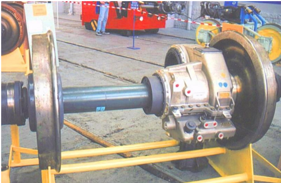
Рис. 4.9. Колісна пара моторного візка з осьовим редуктором.
