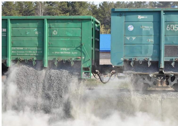
Рис. 7.1. Гравітаційний спосіб вивантаження навалювальних вантажів із напіввагонів
