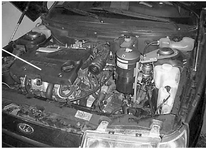
Рис. 1.18. Встановлення ТА на автомобілі ВАЗ 2110/ 11/12 від «АвтоПлюсМАДИ»: вид моторного відсіку зі встановленим ТА (1)
