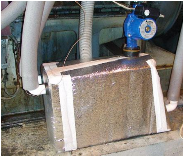
Рис. 4.11. Загальний вигляд теплового акумулятора, встановленого в СКП на дослідних ДВЗ: а – дизель К461М1; б – газовий двигун К159М2
