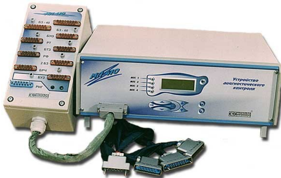
Рис. 8.22. Пристрій діагностичного контролю електронних блоків пасажирських вагонів МЛ-410
