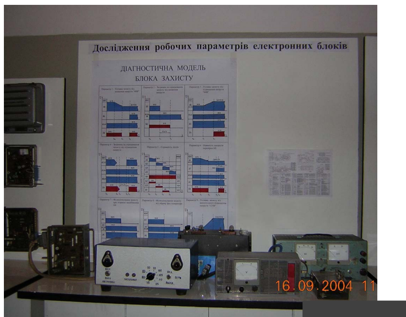
Рис. 8.3. Стенди для випробування та регулювання електронних блоків вагонів
