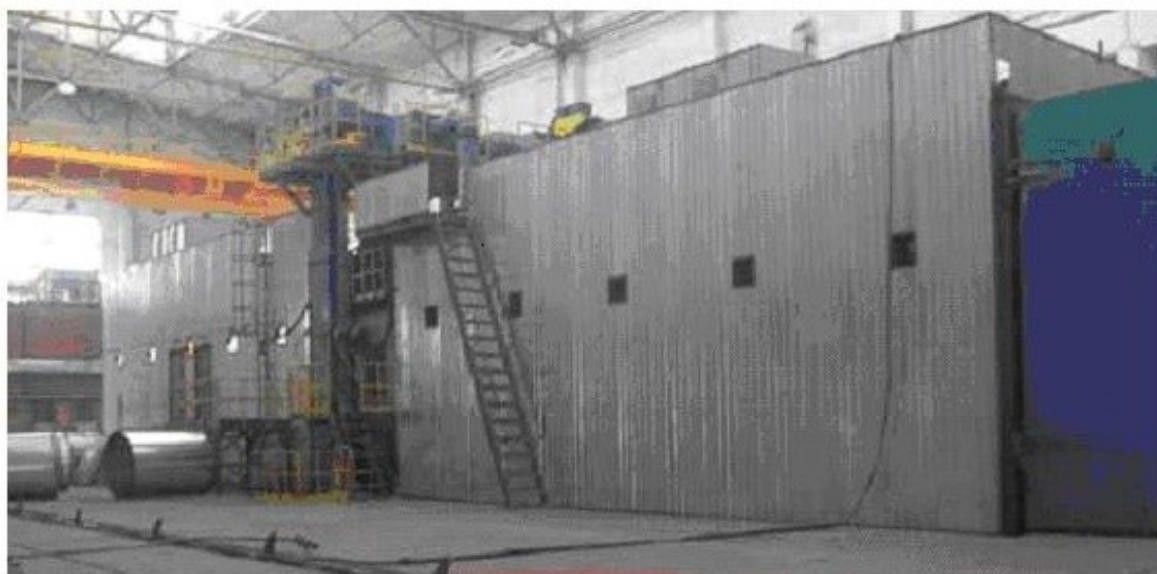
Рис. 5.7. Дробометальна камера для очищення вагонів
