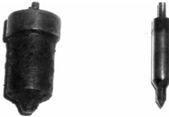
Рисунок 1. Корпус і голка розпилювача паливної форсунки дизеля з значними нагаро-смолистими відкладеннями
