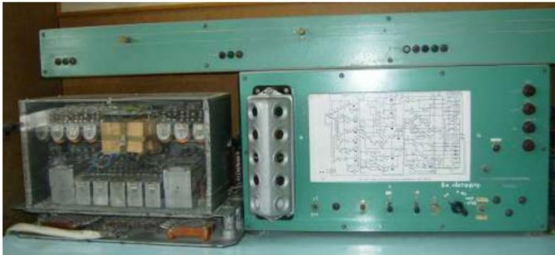
Рисунок 3.6 – Зовнішній вигляд частини дискретного стенду АЛСН без ЕПК та швидкостеміра
