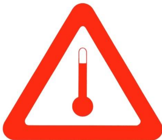
Рис. 4.15. Попереджувальний знак «Підвищена температура»
