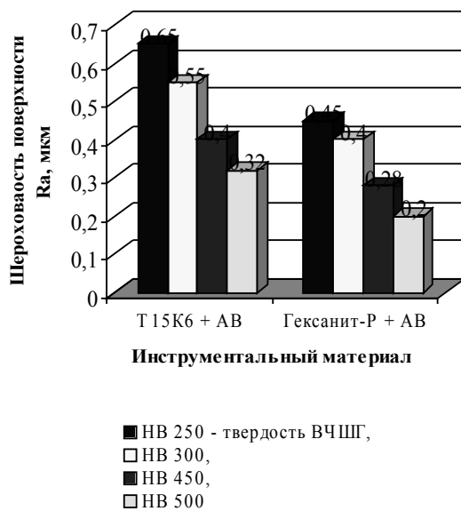
Рис. 1. Толщина упрочненного (белого) слоя (а) и величина шероховатости поверхности (б) после комплексной механической обработки высокопрочного чугуна в различном исходном структурном состоянии
