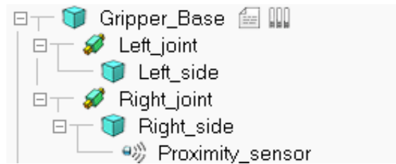
Рисунок 1.11 – Заключна ієрархія сцени з заданою прив'язкою «Proximity sensor» до захвату
