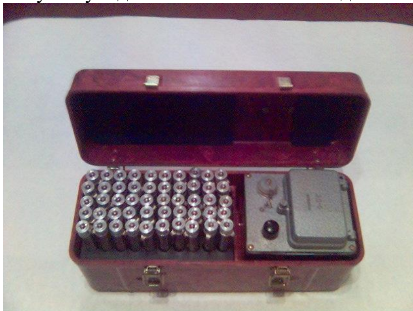
Рисунок 4.10 – комплект індивідуальних дозиметрів ДП-22В
