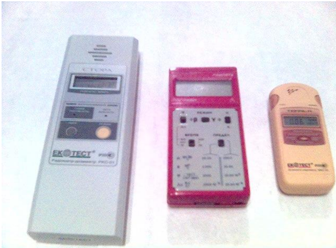
Рисунок 4.17 – дозиметр-радіометр «Стора», «Прип'ять». МКС-05 «ТЕРРА-П»
