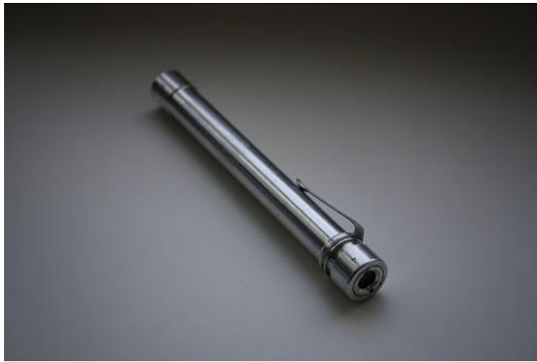
Рисунок 4.11 – індивідуальний дозиметр ДКП-50А
