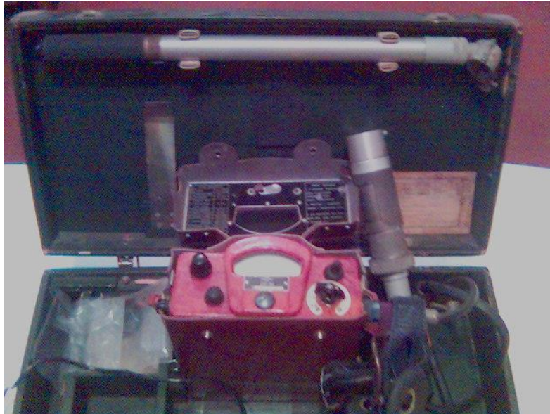
Рисунок 4.9 – дозиметр потужності дози (рентгенметр) ДП-5А
