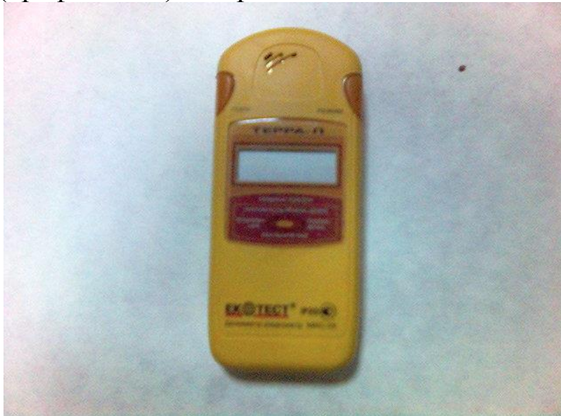
Рисунок 4.16 – дозиметр-радіометр МКС-05 «ТЕРРА-П»
