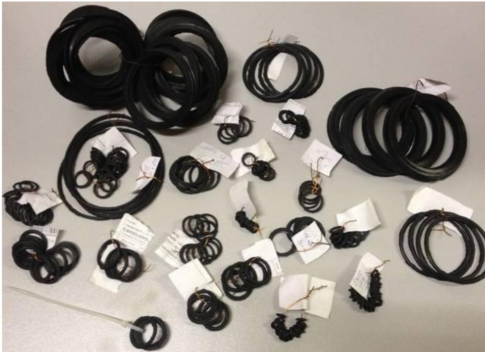
Рисунок 2 – Гумотехнічні вироби для гідравлічної передачі потужності тепловозів
