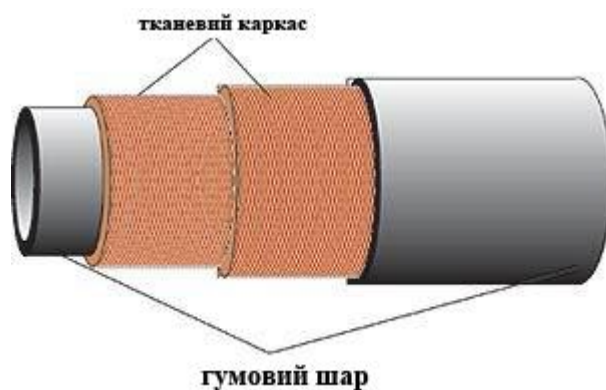
Рисунок 3 – Структура дюритових рукавів
