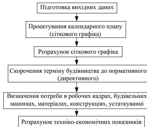
Рисунок 2.1 – Укрупнена блок-схема проектування календарного плану (сіткового графіка) будівництва об'єкта
