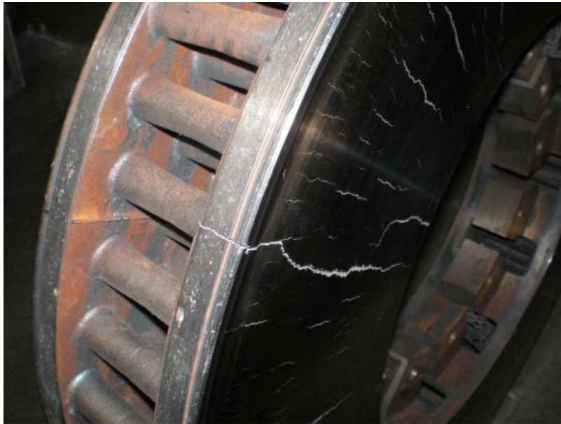
Рисунок 6 – Мікротріщини на диску
