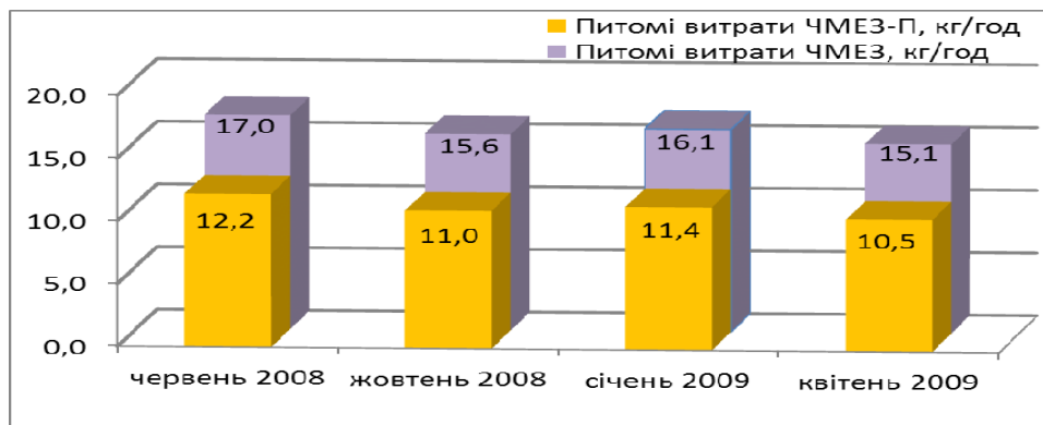
Рисунок 2. – Порівняння питомих витрат палива тепловозів ЧМЕЗ і ЧМЕЗ-П при роботі на станції Попасна
