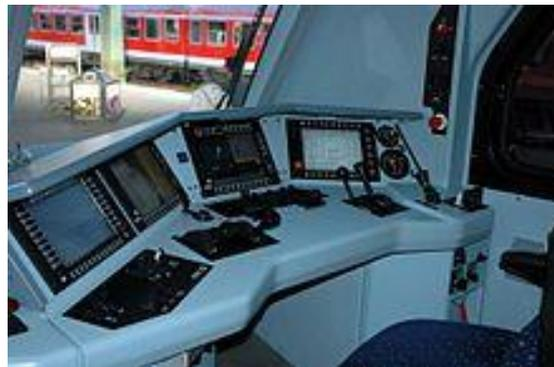
Führerstand einer modernen Elektrolokomotive
