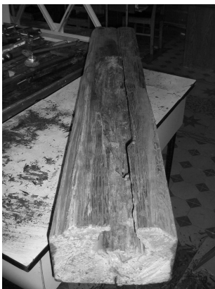
Рис.1 – Старогодная шпала, готовая для инъектирования
