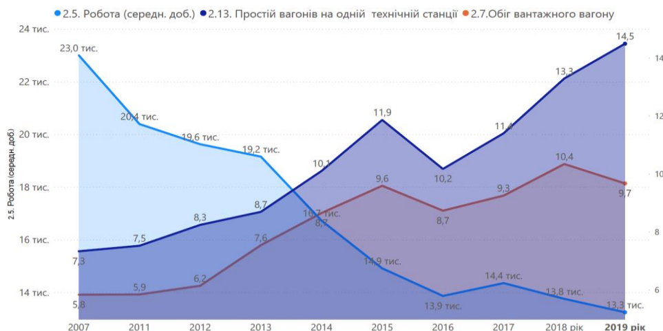
Рис. 2. Динаміка зміни роботи, обігу вагона та простою вагонів на одній технічній станції за період 2007, 2011-2019 рр.
